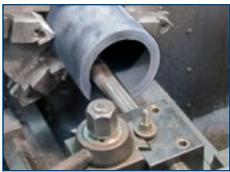
采用在青铜上使用的相同的传统加工技术，但加工时采用干加工，未使用冷却剂。应使用碳化钨尖端工具，以保持表面的精细光滑。
