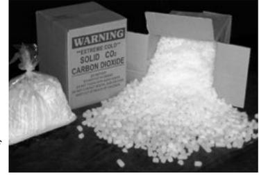
仅在无法获得液氮时, 才会推荐使用装有干冰和酒精(甲醇或乙醇)的冷却槽冷冻装配 DuraBlue®。
